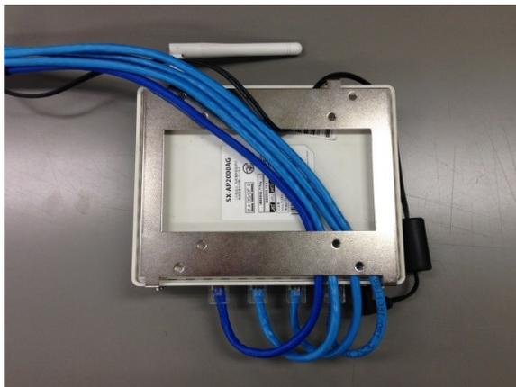
設置面より各ケーブルを金具開口部より通し、LAN ケーブルは LAN ポート側に、電源コードは電源コネクタ部と反対側に出します。(図 7.④)
