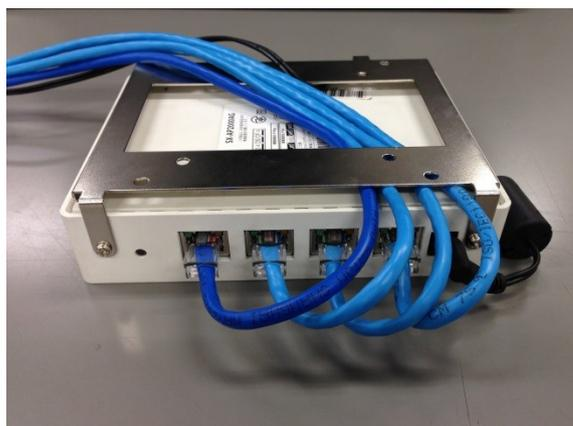
LAN コネクタの LAN ポートへの接続は、メンテナンスなどの便宜上、元から来ているケーブル (青色) を向かって左の LAN ポートに接続してください。それ以外の送り側のケーブル (水色) を残り 3 ポートに接続してください。(図 7.⑤)
